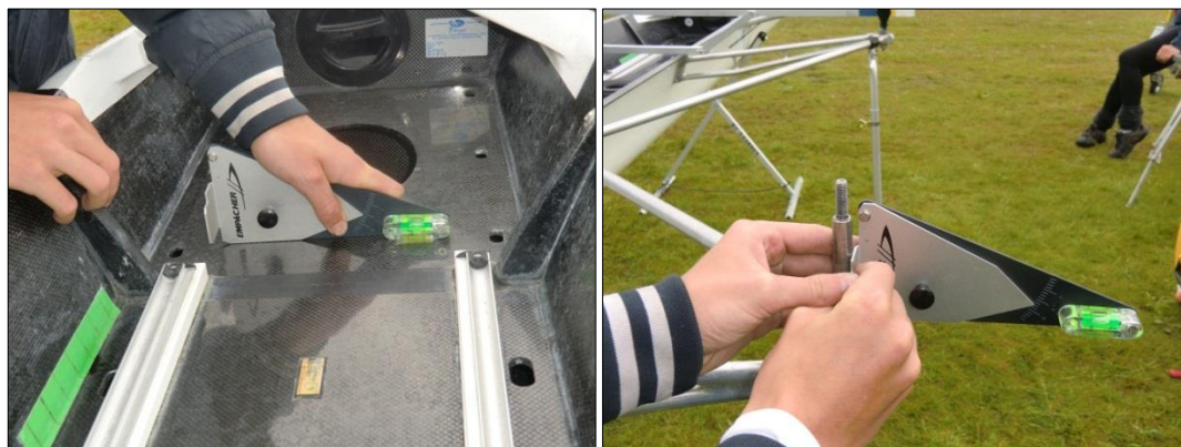
Links het ijken van de dolhoekmeter, rechts het opmeten van de buitenwaartse dolpenhoek
